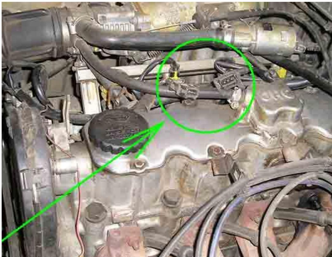
Фазы газораспределения проверяются при помощи датчика разрежения.
