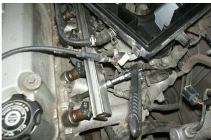
Сейчас форсунки удерживаются в рампе только на уплотнительных кольцах. На некоторых автомобилях форсунки удерживаются в рампе при помощи специальных скоб. Аккуратно (чтобы не повредить резиновые уплотнения) извлекаем форсунки из топливной рампы.
