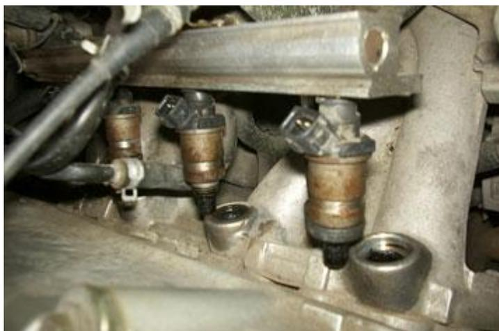
Вынимаем уплотнительные кольца из отверстий в коллекторе и осматриваем на предмет повреждений. Поврежденные уплотнения меняем на новые. Хорошее правило - иметь комплект расходных материалов.
