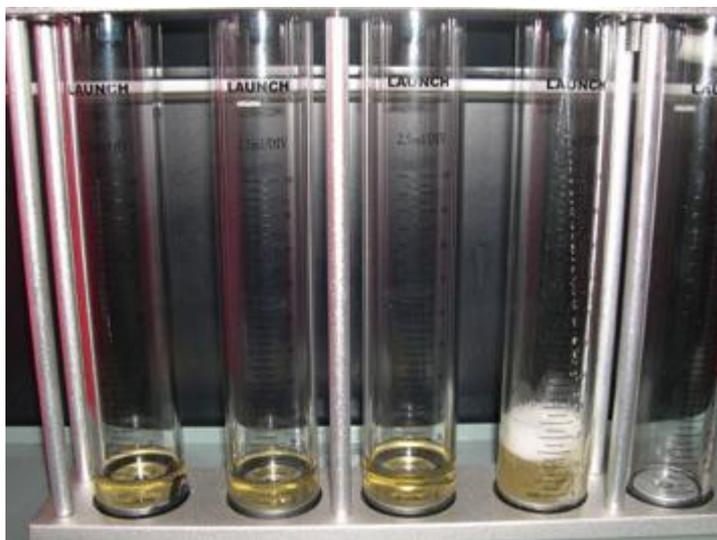
На рисунке нетипичный случай - при изменении режима тестирования клапан одной из форсунок "залип". При переходе в другой режим он встал на место. Позже во всех режимах форсунка вела себя вполне адекватно. Обычно негерметичность форсунки проявляется в образовании капель...
