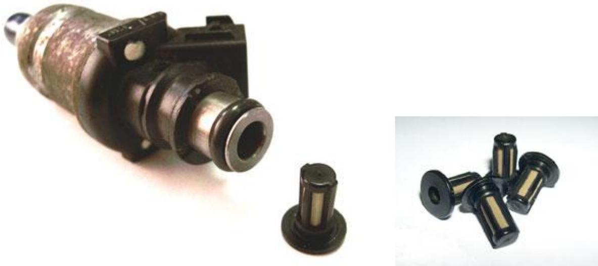
Эти фильтры имеют весьма опрятный внешний вид. При отсутствии специального инструмента для извлечения входных фильтров форсунок, используем "народные средства". Подбираем подходящий по размеру саморез. Действуя осторожно и аккуратно, вкручиваем его внутрь фильтра, не разрушая его.
