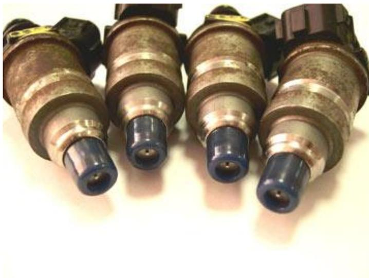
Однако борьба с внешним загрязнением - не наша цель. Только при помощи ультразвука возможна эффективная очистка внутренних полостей. Этим обстоятельством мы и воспользовались. А для того, чтобы проверить качество очистки, протестируем форсунки еще раз.
