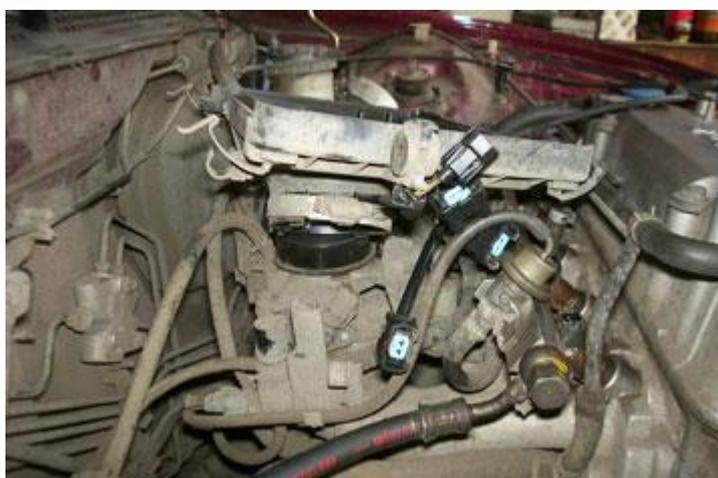
Отворачиваем гайки крепления топливной рампы к впускному коллектору... и аккуратно извлекаем рампу вместе с форсунками.
