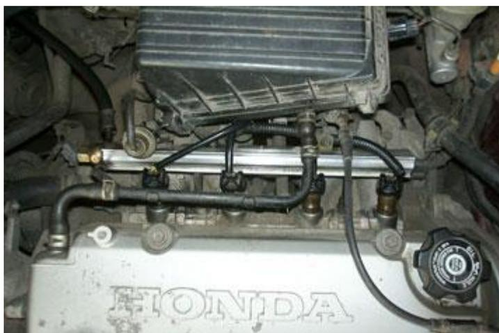
Для удобства доступа к топливной рампе демонтируем воздушный фильтр.
