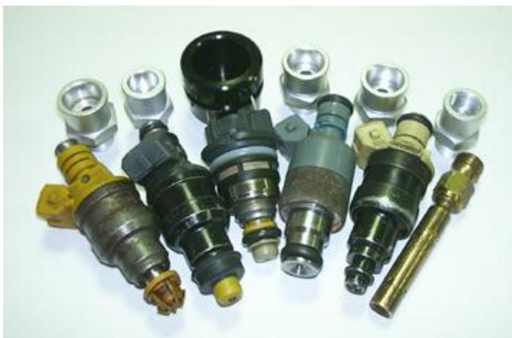
Форсунки могут также отличаться и сопротивлением электрической обмотки. В современных стендах реализован принцип адаптивного управления и нам нет необходимости обращать внимание на возможные отличия. В более простых установках необходимо будет измерить электрическое сопротивление обмотки и установить соответствующее ему напряжение. Перед установкой форсунок на топливную рампу обязательно надо смазать уплотнительные кольца, чтобы не повредить их. Проще всего это сделать при помощи WD-40.
